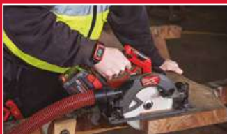
553 cortes en madera blanda de 50x100mm con M18 FB12 (M18 FCS66)
